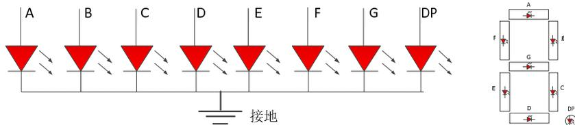
平台包含一个 8 位的十六进制数码管，该数码管共用 4bit 位宽的数据位，同时由 3bit 的选择位经译码后生成 8 个选择信号，控制 8 个数码管的使能，数据位个选择位信号都是高电平有效。其工作原理如下图所示。
